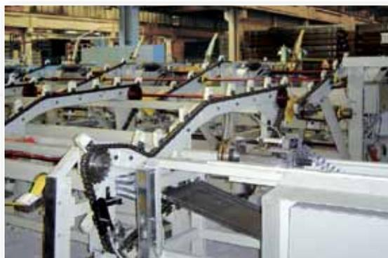
Battente arresto tubi della via a rulli
